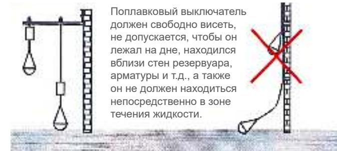
Поплавковый выключатель должен свободно висеть, не допускается, чтобы он лежал на дне, находился вблизи стен резервуара, арматуры и т.д., а также он не должен находиться непосредственно в зоне течения жидкости.
